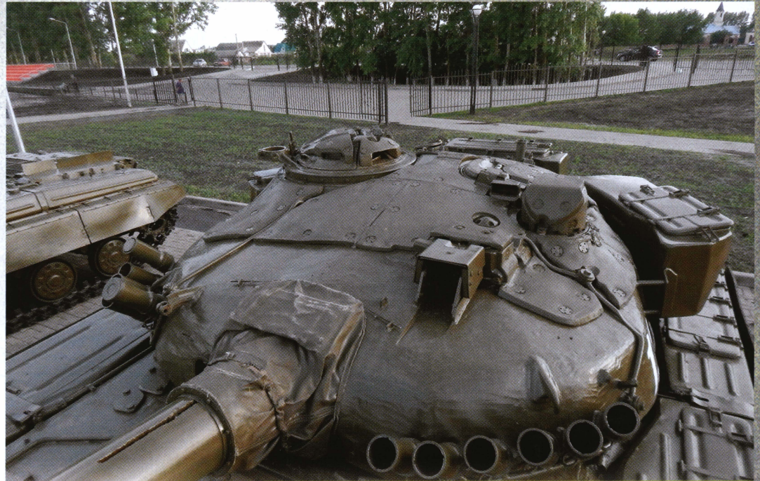
Вид сверху на башню танка Т-72А. Обратите внимание на крепление противоатомного надбоя.
