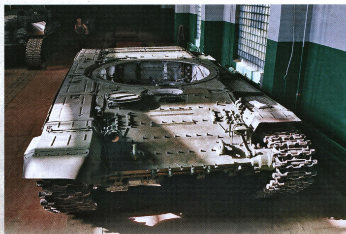
Корпус танка Т-72Б со снятыми элементами динамической защиты. Хорошо видны люк механика-водителя и дополнительные топливные баки на надгусеничных полках.
